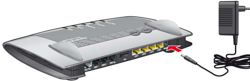
Anschließen der Stromversorgung
